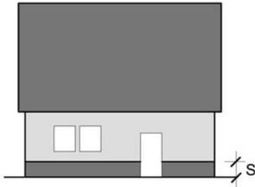
(15) **Sockel** sind farblich und/oder durch Materialwahl von der übrigen Außenwand abzusetzen. Bei Klinkerfassaden sind zusätzlich Versatz, Sims oder Wechsel im Mauerwerksverband (z.B. Rollschichten) zulässig. Sockel sind als Klinkersockel, Feldsteinsockel, verputzt mit eingefärbtem Oberputz oder mit Anstrich auszuführen. Buntsteinputze sind zulässig in Farbmischungen mit überwiegendem Anteil grau, braun und rot.
