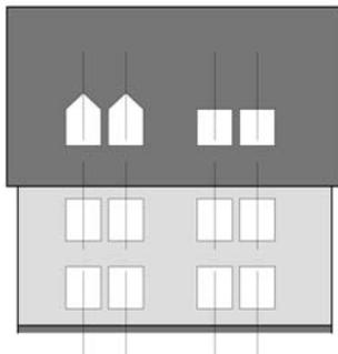
(7) **Giebelfenster** sind symmetrisch zum First auszuführen. Der Abstand zwischen oberer Fensterecke und Beginn der Ortgangkonstruktion muss mindestens 0,50 m betragen (gemessen rechtwinklig zum Ortgang).
